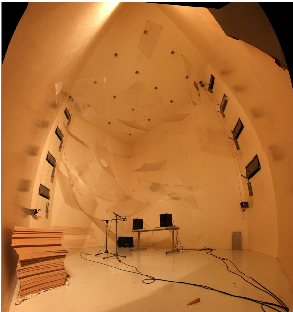
Obr. 1.7 Pohled do dozvukové komory FEL [x]
