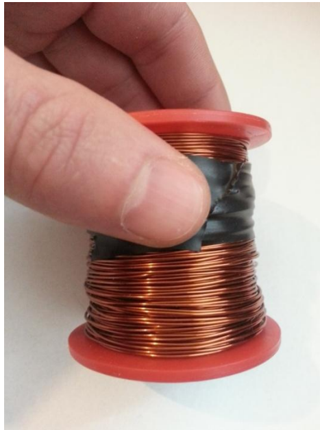
(Obr. 9) Lakovaný vodič pro primární vinutí (0,6 mm)
