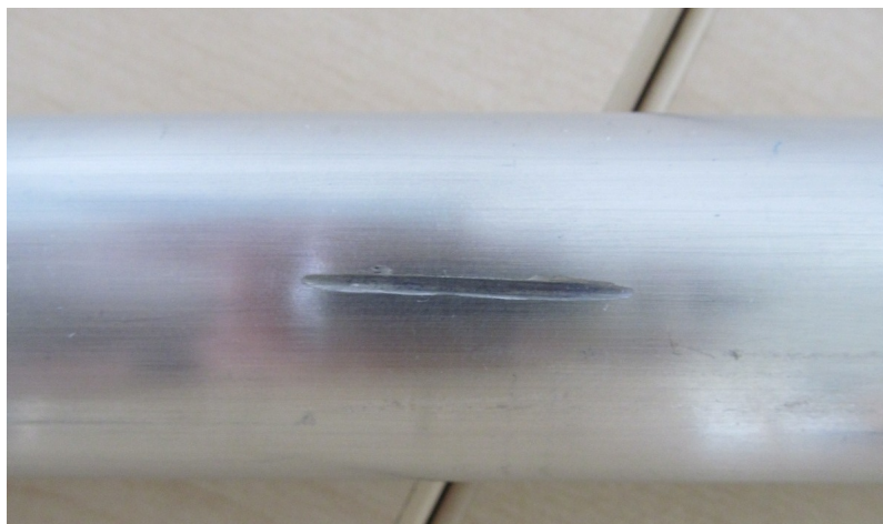
Obr. 4.15: Podélná vada č. 2 - foto
