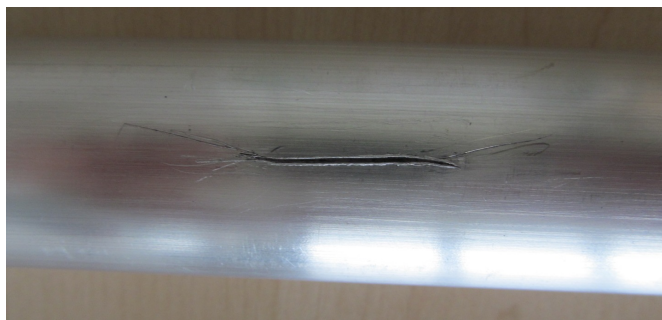
Obr. 4.12: Podélná vada č.1 - foto
