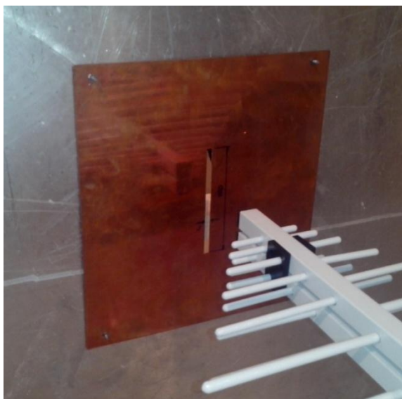
Obr. 1.1 Ukázka štěrbinového otvoru 100mm při horizontální polarizaci
