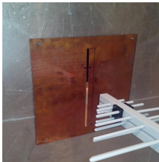
Obr.1.2 Ukázka štěrbinového otvoru 200mm při horizontální polarizaci
