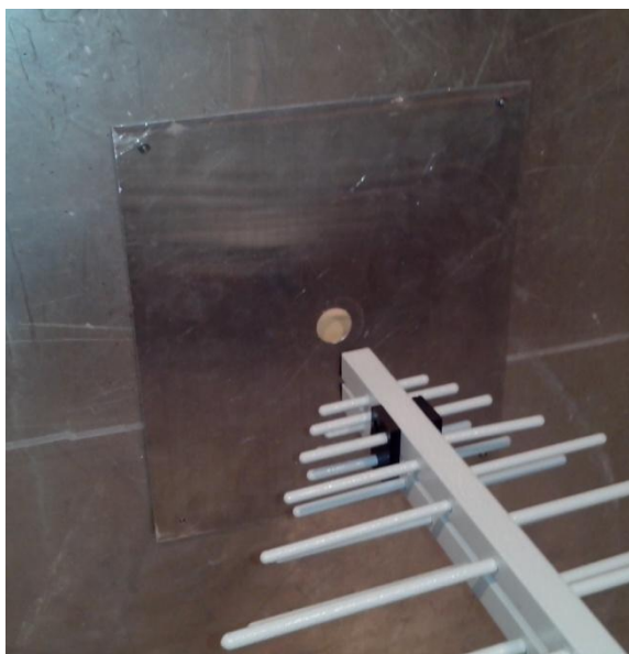
Obr. 1.3 Ukázka kruhového otvoru o průměru 20mm při horizontální polarizaci
