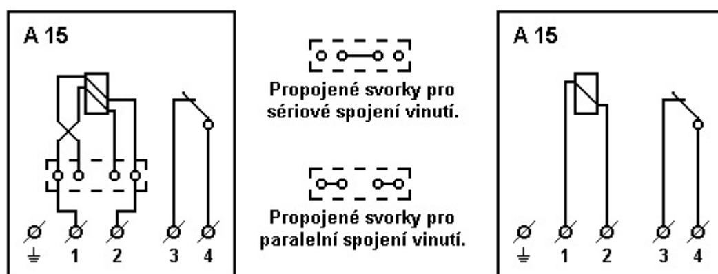
Obr. 5: Dvouvinutové provedení včetně přepínacích cívek a jednovinutové provedení [6]
