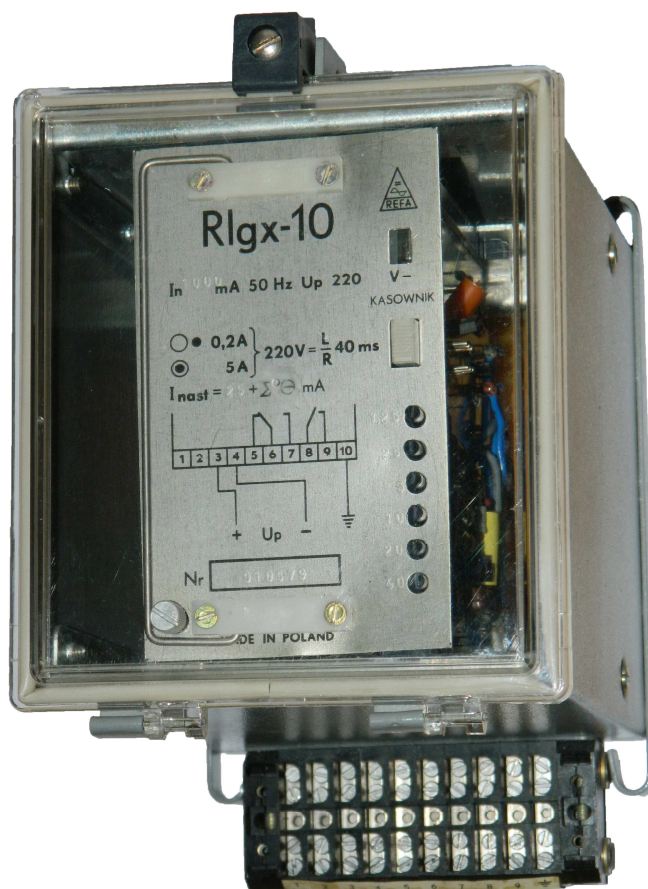
Obr. 8: Zemní ochrana RIgx-10
