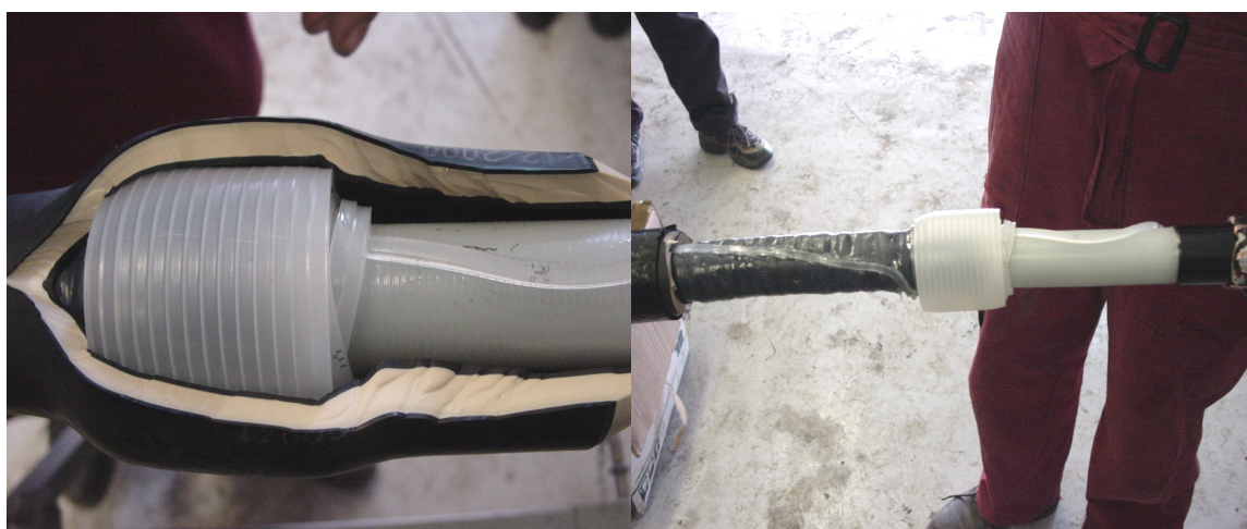
Obrázek 3: Pružina v těle spojky
