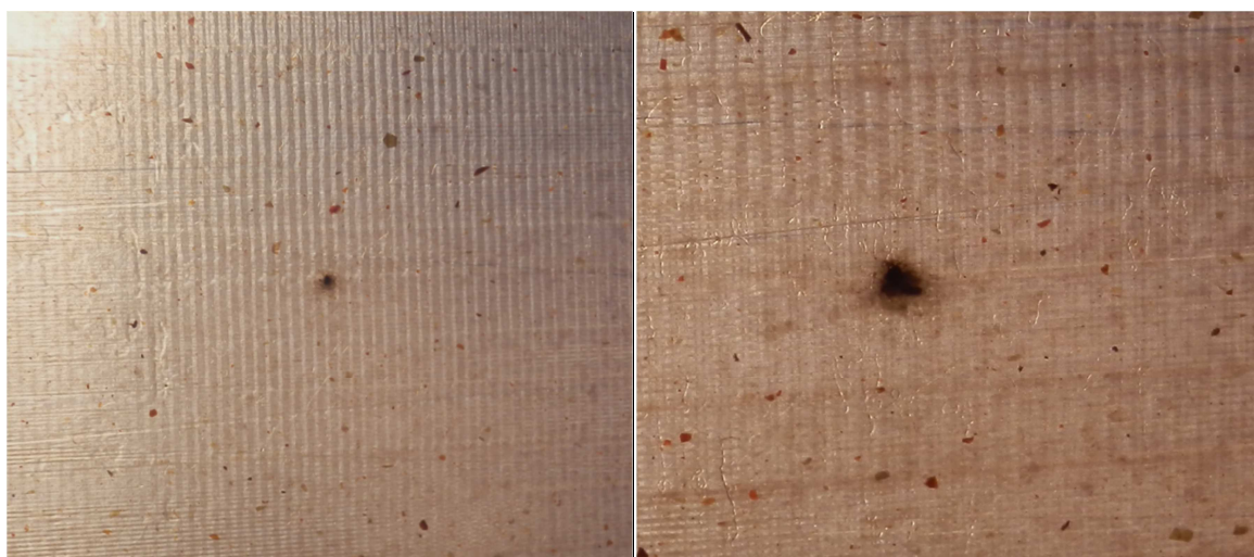
Obr. B.4 Detail místa průrazu materiálu Relanex 45. 033, stejnosměrné napětí: a) krátkodobá zkouška, b) zkouška se stupňovitým zvyšováním napětí
