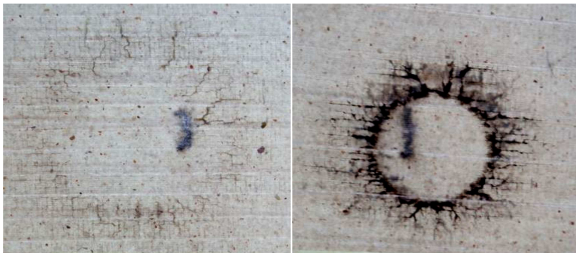
Obr. B.3 Detail místa průrazu materiálu Relanex 45. 033, střídavé napětí: a) krátkodobá zkouška, b) zkouška se stupňovitým zvyšováním napětí
