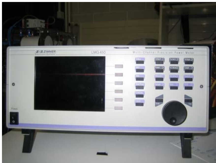
Obr. 2.13 Analyzátor výkonu ZES ZIMMER LMG 450
