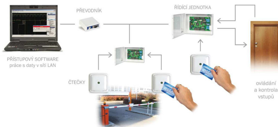
Obr. 9: Schéma přístupového systému. [20]
