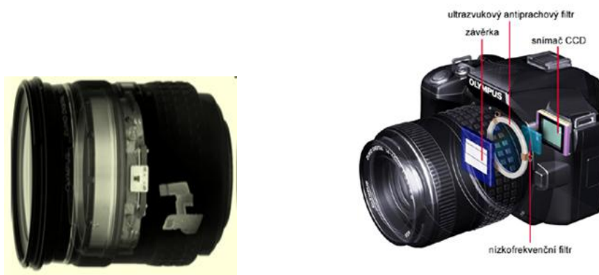
obr 44: Použití piezomotoru k polohování snímače fotoaparátu a antiprachový filtr. [30]
