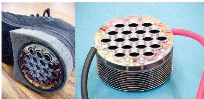
obr 25: Použití piezoelektrického generátoru v patě obuvi [26]
