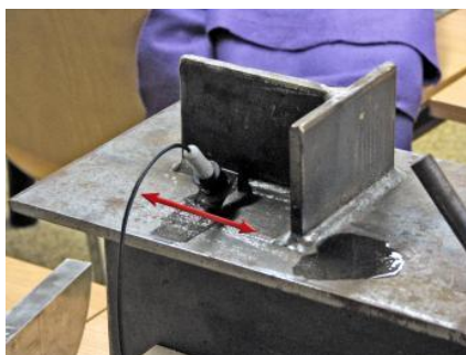
obr 48: Použití ultrazvukového měřicího přístroje s úhlovou sondou pro kontrolu kvality svarů [8]
