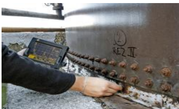
obr. 47: Použití ultrazvukového měřiče pro měření tloušťky materiálu [8]
