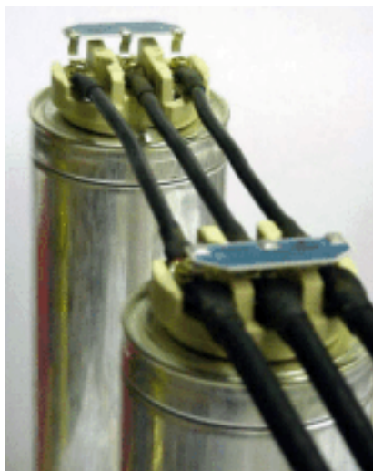
Obr. 8.5 Způsob připojení fóliových vybíjecích rezistorů [12]
