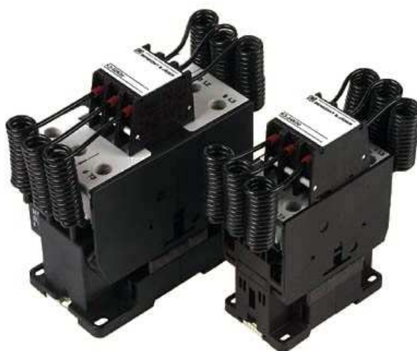
Obr. 9.1 Stykač se vzduchovou tlumivkou tvořenou svinutými přívodními vodiči [16]
