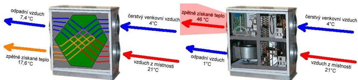
Obr.3.2.1-6 – Srovnání pasivní a aktivní rekuperace (vlevo pasivní, vpravo aktivní), (převzato z [26])
