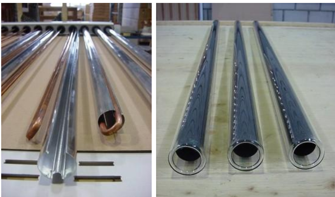
Obr.3.2.3.8 – Trubicový dvojitý vakuový kolektor – U-smyčka z měděného potrubí s hliníkovou lamelou (vlevo) a vlastní vakuová skleněná Sydney trubka (vpravo), (převzato z [18])
