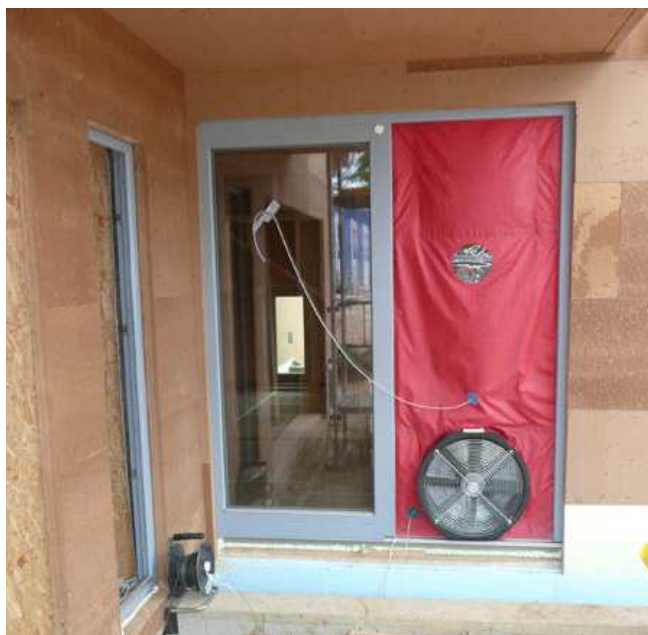
Obr.4. Blower – Door test [20]
