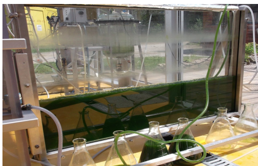
Obr. 12. Kultivace mikrořasy Trachydiscus minutus v panelovém fotobioreaktoru
