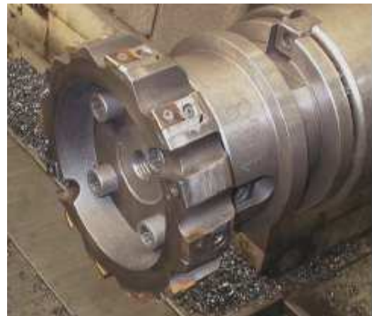
Obr.2.38 Rot. čelní frézování klikového čepu na NC stroji [12] Obr.2.39 Pohled na frézovací hlavu [12]
