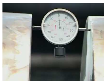
Obr.2.21 Měření „dýchání“ klikové hřídele [14]
