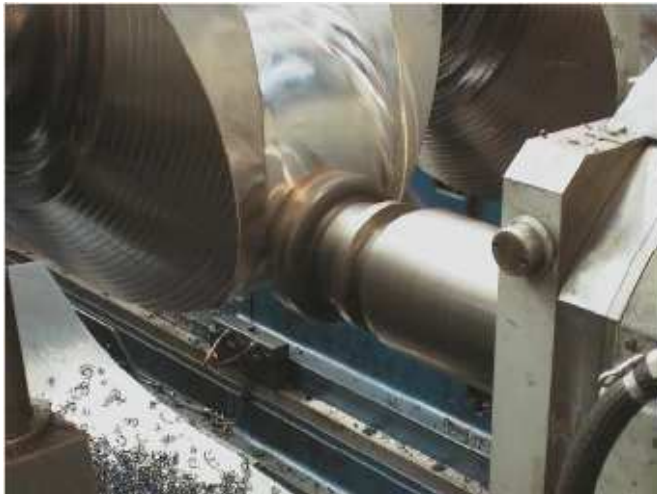
Obr.2.38 Rot. čelní frézování klikového čepu na NC stroji [12] Obr.2.39 Pohled na frézovací hlavu [12]
