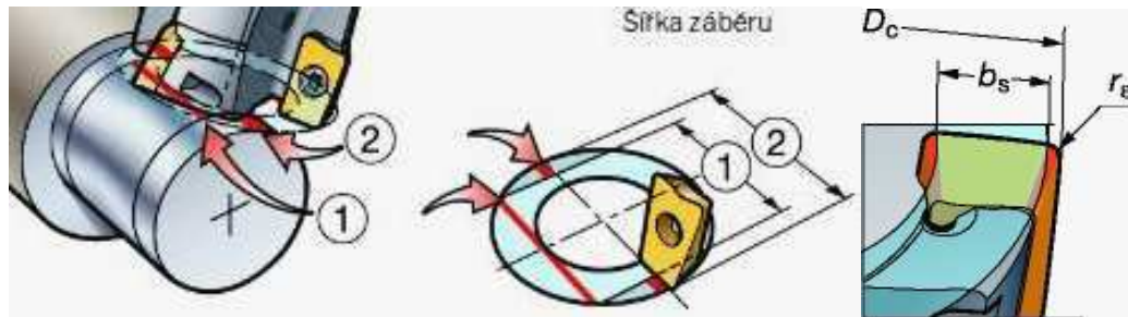
Obr.2.40 Závislost šířky záběru (šířky válcové plochy na obrobku) a počtu excentrických posunutí nástroje na čelním rozměru b_s vyměnitelné břitové destičky [13]
