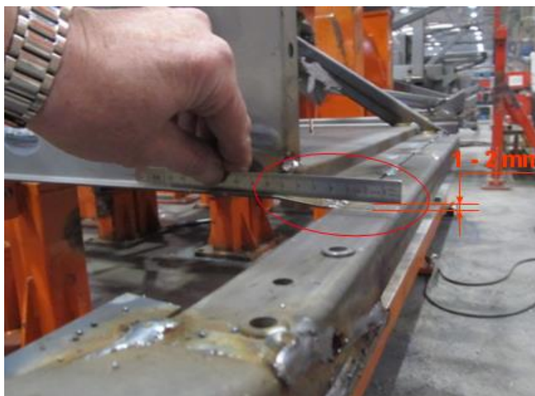
Obrázek 30 - Plechování není v rovině s prahem
