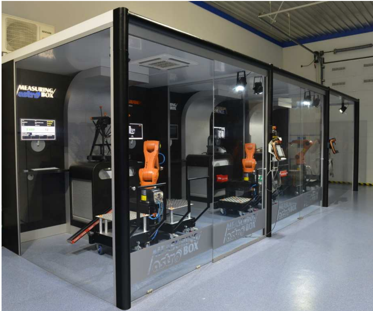
obr. 50 Modulární uspořádání tří boxů s měřidly Equator, IM6010 a značícím strojem Technomark
