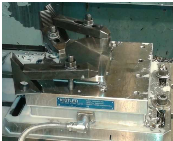
Obr. 4-8 Nedostatečné upnutí obrobku
