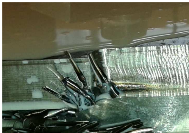
Obr. 4-8 Nedostatečné upnutí obrobku
