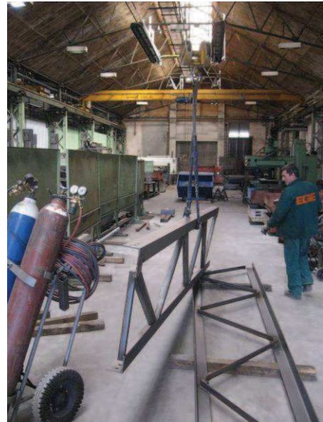
Obr. 3-11 Pravá a levá stěna stožárového dílu a jejich manipulace.
