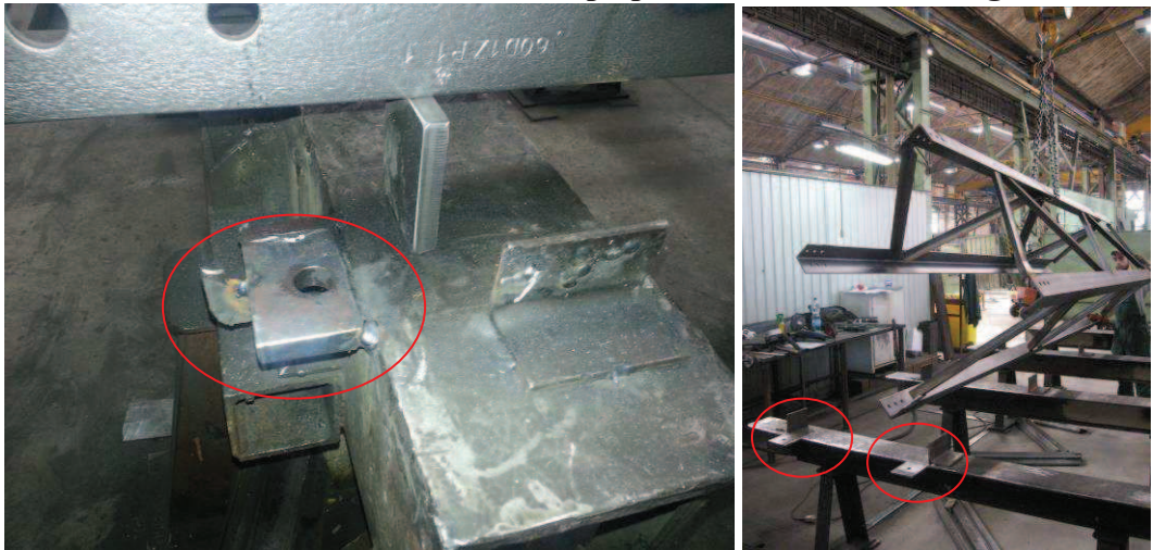
Obr. 3-10 Místo pro vycentrování stožárového dílu s dorazem a bez dorazu
