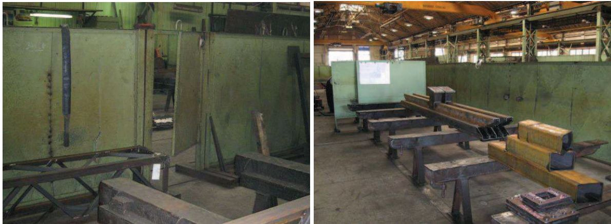
Obr. 3-1 Svářecí pracoviště ohraničené mobilními plechovými zástěnami
