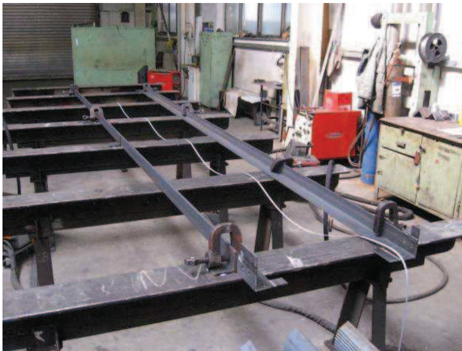
Obr. 3-15 Umístění rohových stojin do přípravku
