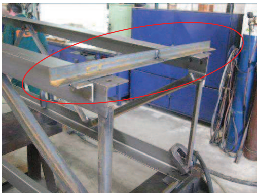
Obr. 3-12 Horní prvky svařovacího přípravku.
