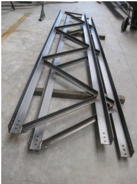
Obr. 3-11 Pravá a levá stěna stožárového dílu a jejich manipulace.
