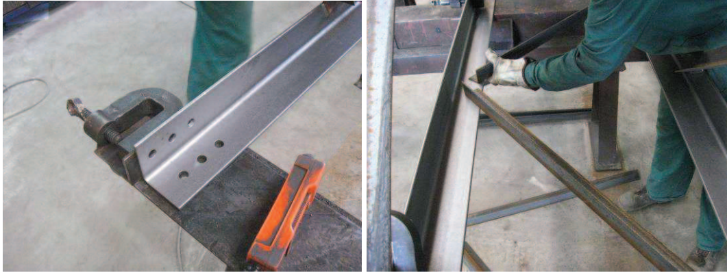
Obr. 3-9 Ustavení bočního dílu do přípravku a rozmístění diagonál
