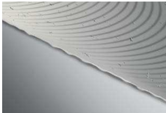
Obr. 1-26 - Zdrsněný povrch a špatná kvalita povrchu obrobku převzato z [9]
