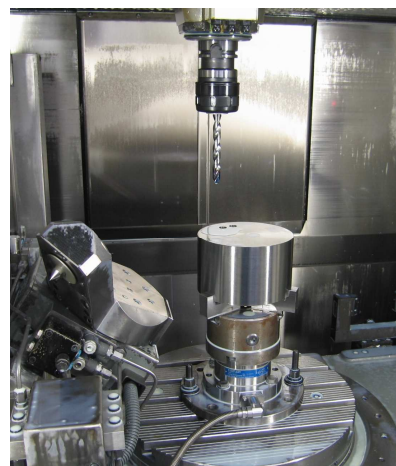
Obr. 4-5 - Upnutí obrobku v dynamometru
