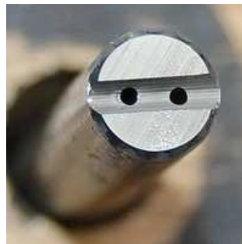
Obr. 2-2 - Drážka přes chladící kanálky převzato z [VIII]
