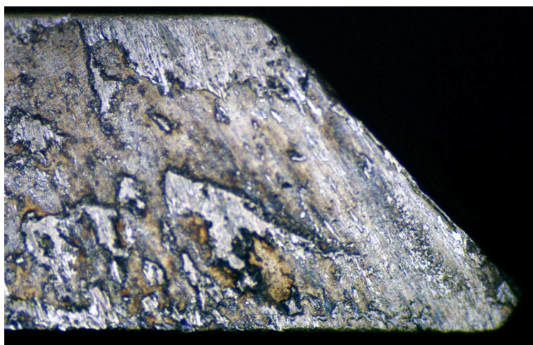
Obr. 4-17 Obr. 4-18 – Stav obvodové fasety, pravá strana, otvor č. 66 – navržený nástroj
