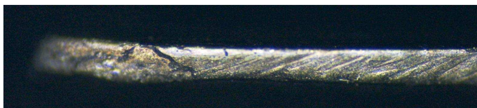
Obr. 4-22 – Stav ochranné fasety na hlavním ostří, pravá strana, otvor č. 66 – navržený nástroj
