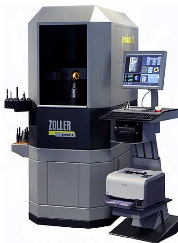
Obr. 2-4 - Měřící centrum ZOLLER genius převzato z [XVIII]
