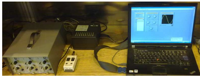
Obr. 33. Schéma pracoviště pro měření řezných sil
