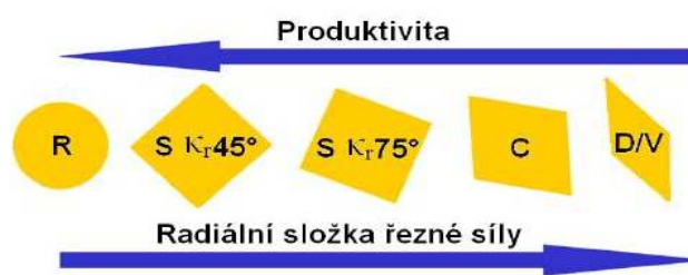
Obr. 12. Závislost produktivity destičky na radiální složce řezné síly [28]
