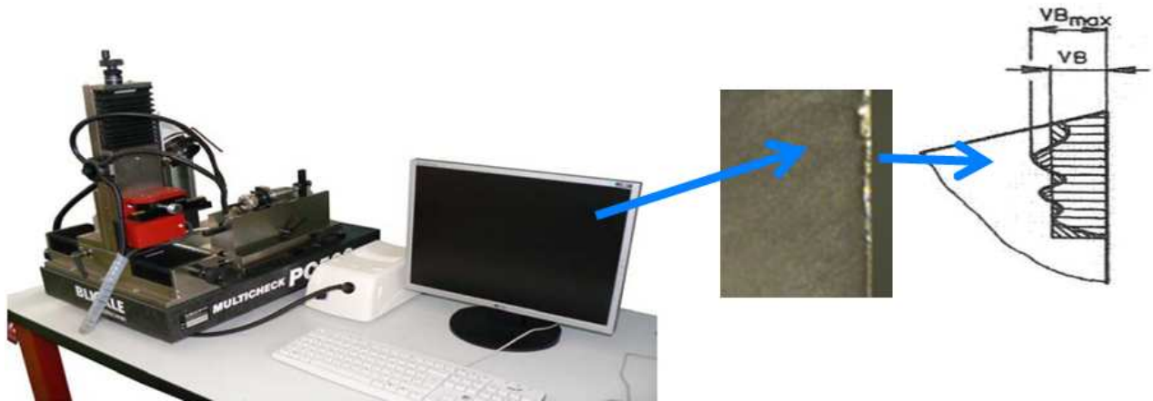
Obr. 35. Schéma pracoviště pro měření opotřebení na nástroji
