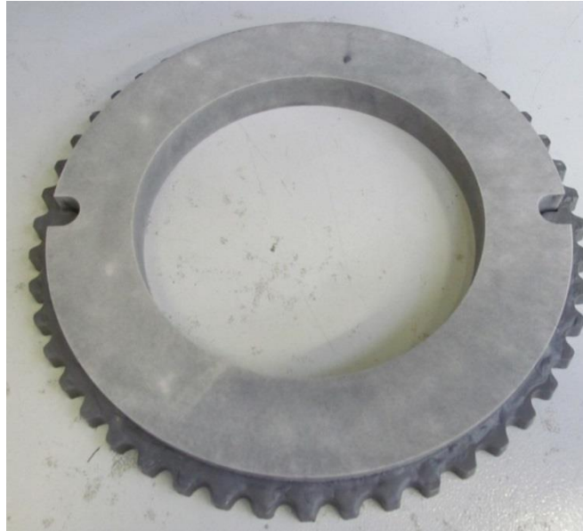
Obr. 3-12 Fotografie orovnávacího kotouče v unášeči [autor]
