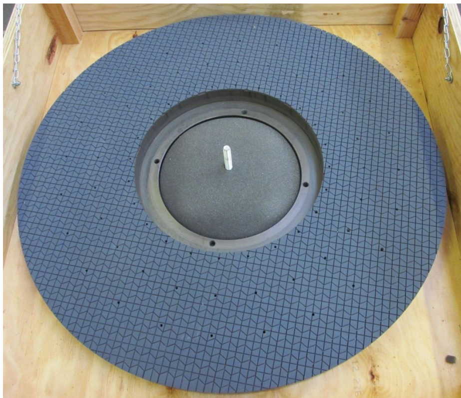
Obr. 3-5 Foto vylepšené specifikace brusných segmentů (šířka mezi segmenty 1 mm) [autor]
