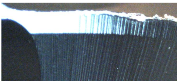
Obr.3.2.3.3.1b Nástroj 2 po 14 a 36 minutách obrábění
