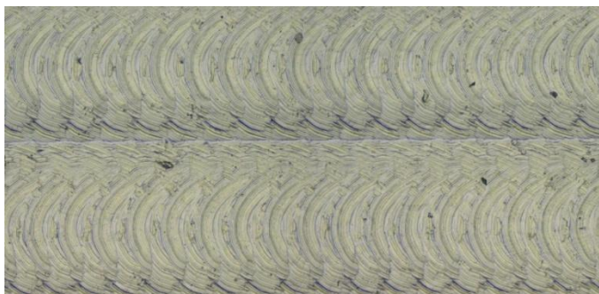
Obr.3.2.3.3.2b Povrch po obrobení nástrojem 2
