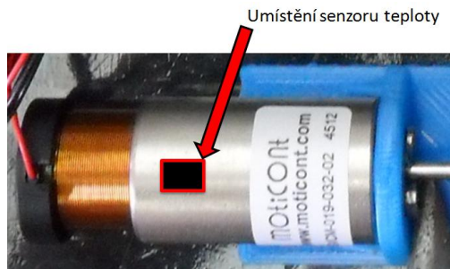
6.4 – Umístění senzoru teploty VCA pohonu
