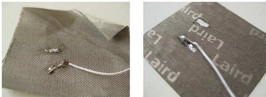
Obr. 3.10 Pájení ruční páječkou (převzato z [60])
