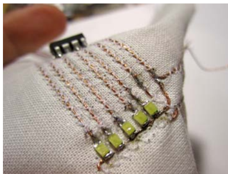
Obr. 3.11 Měděné vlákno spojené s elektrotechnickými součástkami pomocí pájení (převzato z [60])
