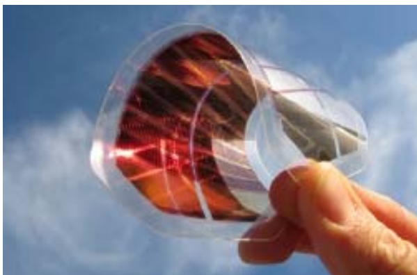
Obr. 2.10 Ohebný fotovoltaický článek na polymerové bázi (převzato z [25])
