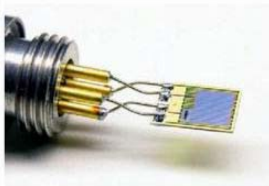
Obr. 3.2 Kapacitní senzor vlhkosti a teploty (převzato z [35])
