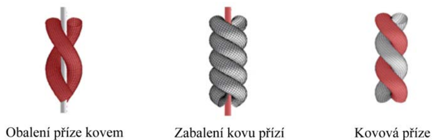
Obr. 3.6 Směšování textilních a vodivých (červený) vláken (převzato z [53])
