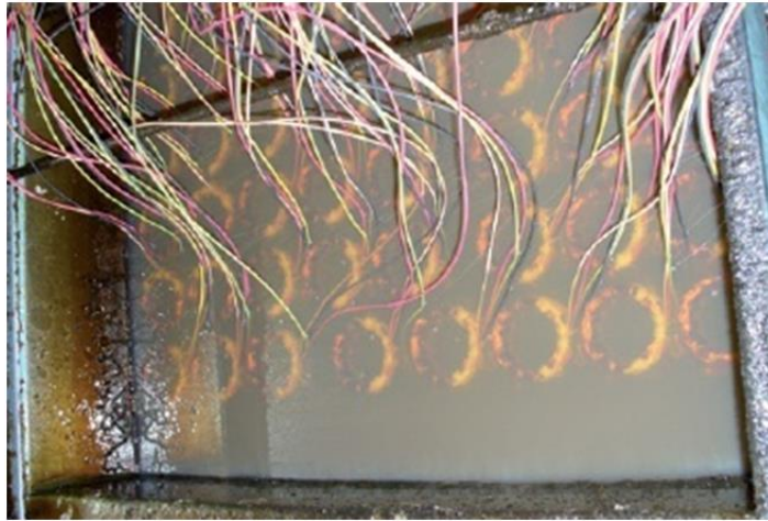
Obr.4.2 Navinuté pakety namočené v impregnantu, převzato z [19]
