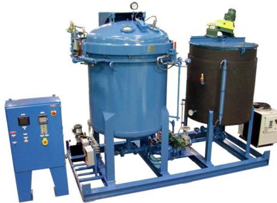
Obr.5.4 VPI linka, převzato z [27]
