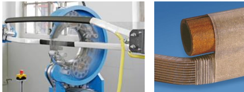
Obr.5.3 a) Kontinuální navíjení páskou, b) diskontinuální navíjení fólií, převzato z [25], [26]
