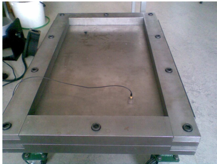
Obr.24 -deska vetknutá mezi hranoly
