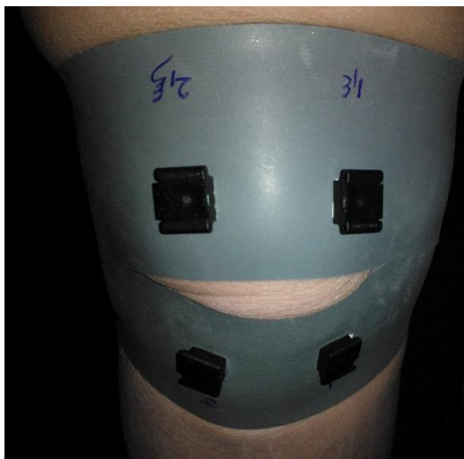
Obr. 3.1.1.5. Uspořádání akcelerometrů (metoda 2, poloha 1)
