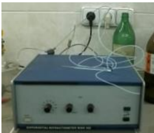
Obr. 15 Refraktometrický detektor RIDK 102
