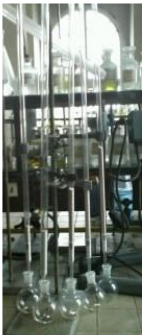
Obr. 22 Chromatografické trubice s frakcemi po zpracování preparativní TLC
