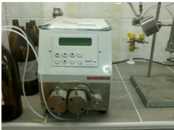
Obr. 9 Preparativní pístové čerpadlo CPI 03 (LABIO a.s.)
