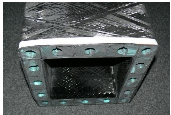
Obr. 66 – Náhled řezu komůrkového kompozitního vřeteníku s tlumicími výplněmi z PU
