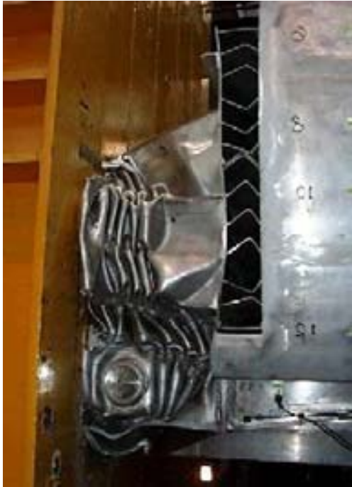
Obr. 51. Hliníkový deformační prvek Alusuisse uvnitř přední konstrukce jednotky Pendolino Britannico (5)
