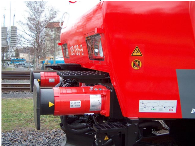
Obr. 24. EST crash nárazník upevněný na lokomotivě BR 185.1 (DB) (8)
