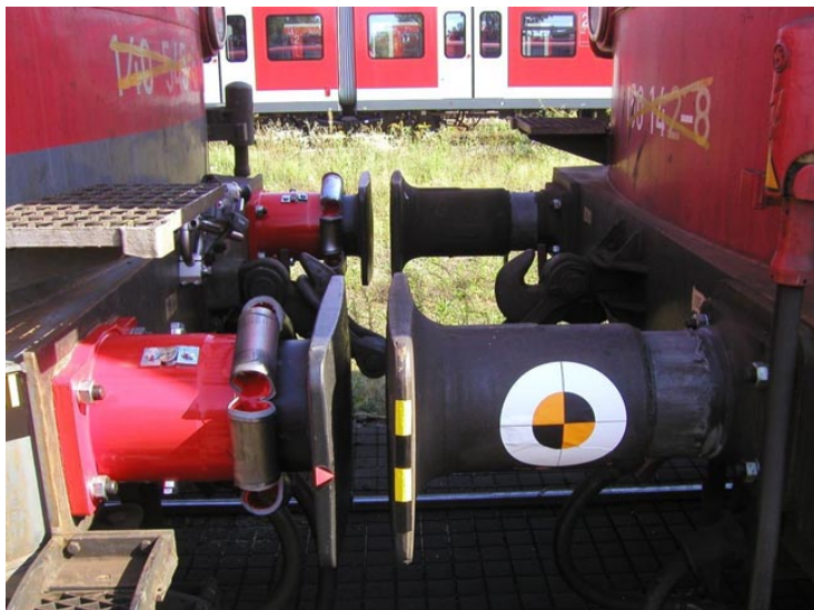
Obr. 25. EST Crash nárazník (vlevo) po nárazovém testu dvou lokomotiv (9) Zde je dobře vidět deformace vnější trubky nárazníku svinováním jednotlivých segmentů.
