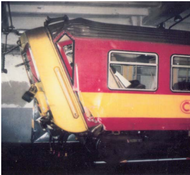
Obr. 2. Skříní motorového vozu ř. 842 po nárazu rychlostí cca 55 \text{ km.h}^{-1} (2)
