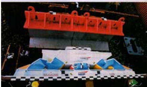
Obr. 52. Dynamické testování deformačního prvku TGV a voštinová konstrukce přední části TGV (5)
