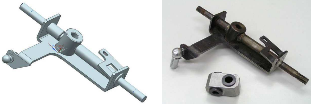
Obr. 8-6: Těhlice (vpravo s kamenem), 3D model - skutečnost
