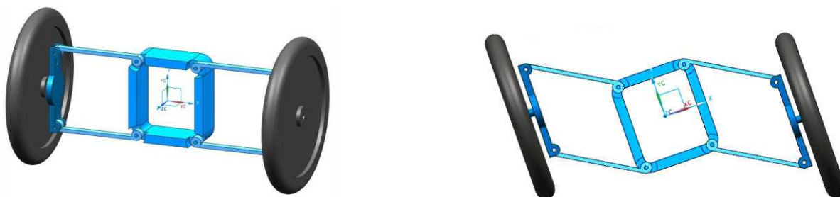
Obr. 2-8: Druhý způsob zavěšení kol umožňující naklápění všech kol
