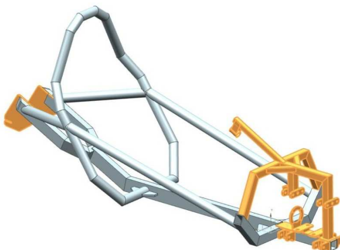
Obr. 8-3: Rám experimentálního vozidla s novými žlutě vyznačenými částmi
