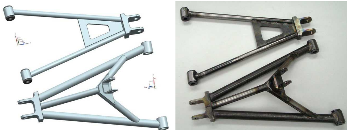
Obr. 8-5: Horní a dolní rameno zavěšení, 3D model - skutečnost
