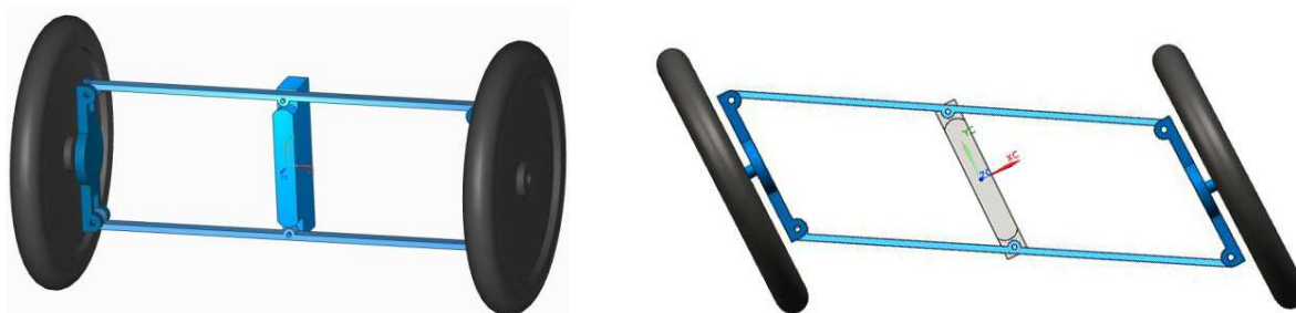
Obr. 2-5: První způsob zavěšení kol umožňující naklápění všech kol
