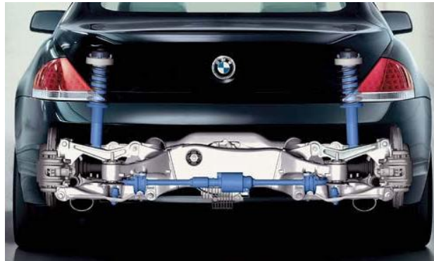
Obr. 12: ACR – Aktivní stabilizátor [23]
