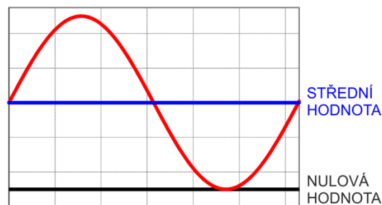
Obr. 32.: Průběh hmotnostního průtoku štěrbinou pulzujícího a mívivého paprsku
