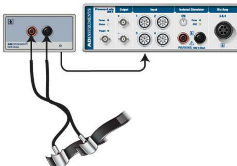
Obrázek č. 6 - Schematické znázornění měřicího přístroje ADINSTRUMENT Power Lab spolu se zesilovačem ML 116 GSR Amp a elektrodami (Benešová 2011).
