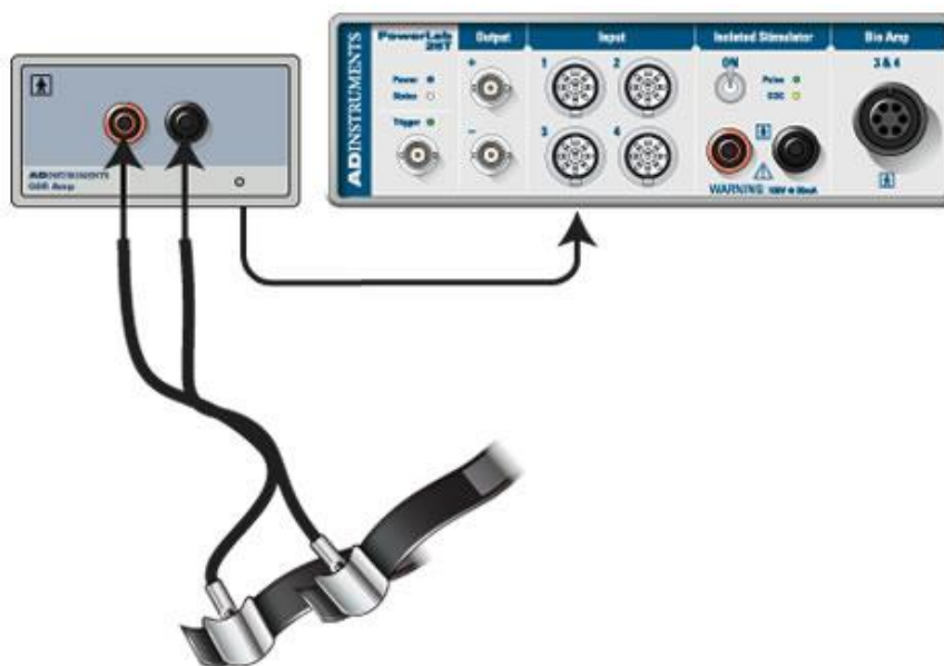
Obr. 10 Power Lab 8/30 s elektrodami a zesilovačem ML116 GSR Amp ( http://www.adinstruments.com , dne 20. 6. 2014)
