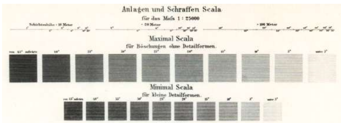
Obr. 11 Ukázka maximální (nahore) a minimální (dole) stupnice šrafování (Zeichnungsschlüssel... 1875).
