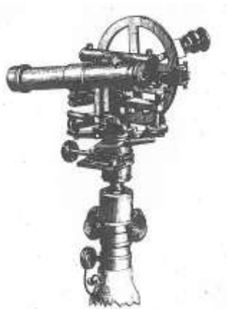
Obr. 14 Výškoměr topografa používaný po roce 1878 (Boguszak a Císař 1961, 25).
