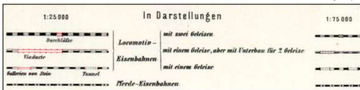
Obr. 5 Ukázky znázorňování prvků polohopisu pomocí bodových a liniových mapových znaků (Zeichnungsschlüssel zur Darstellung... 1875).
