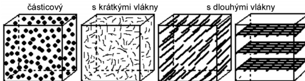
Obrázek 2.3: Rozdělení kompozitních materiálů podle tvaru výztuže [15].
