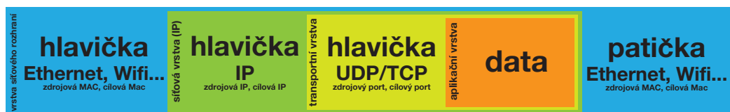
Obrázek 3.2: Schéma zapouzdření dat v TCP/IP.
