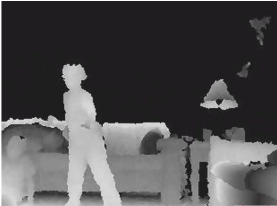
Obrázek 4.3: Ukázka hloubkové mapy pořízené zařízením Kinect. Převzato z [Hoiem 2012]
