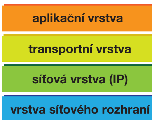
Obrázek 3.1: Vrstvy architektury TCP/IP.
