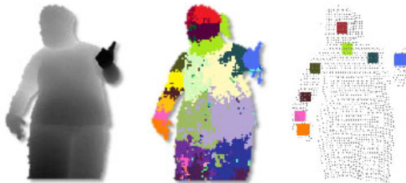
Obrázek 4.4: Ukázka nalezení jednotlivých částí těla na hloubkové mapě uživatele. Převzato z [Hoiem 2012]
