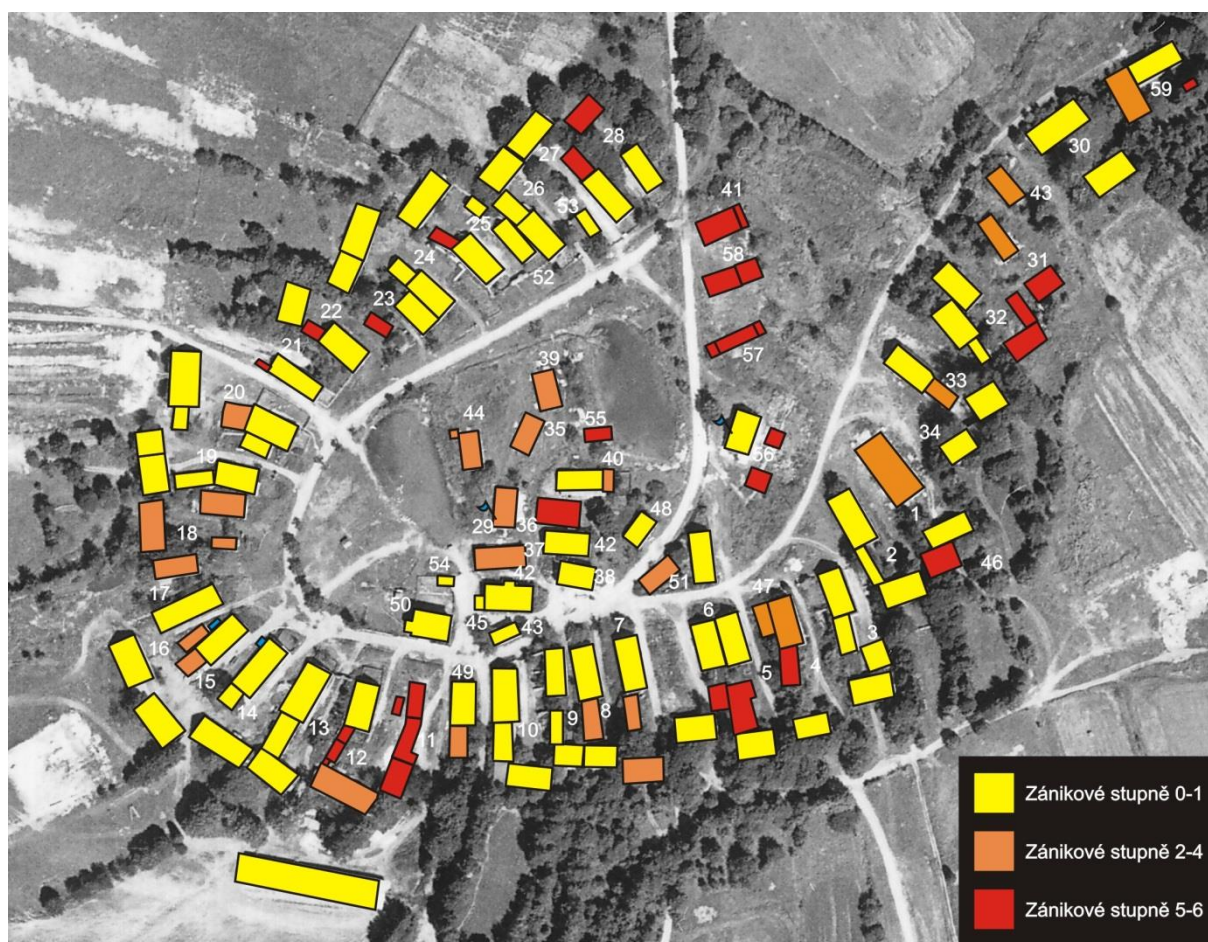
Obrázek 42: Hodnocení stavu objektů v létě roku 1958 pomocí aplikování analytického nedestruktivního průzkumu lokality na letecký snímek
