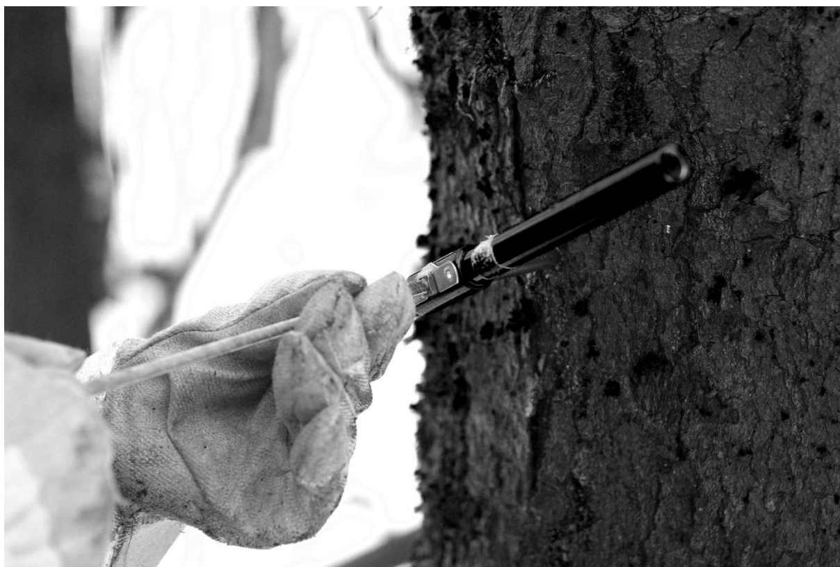
Obrázek 11: Odebírání vzorku pomocí Presslerova nebozezu, zaniklá vesnice Lučina/Grafenried okr. Domažlice. Foto: Lukáš Funk, Zdroj.: (Funk – Váňa 2012)
