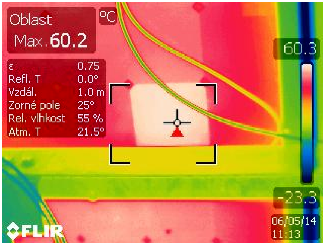
Obr. 21 Zadní kontrola vadného článku (pozice 10.4.)
