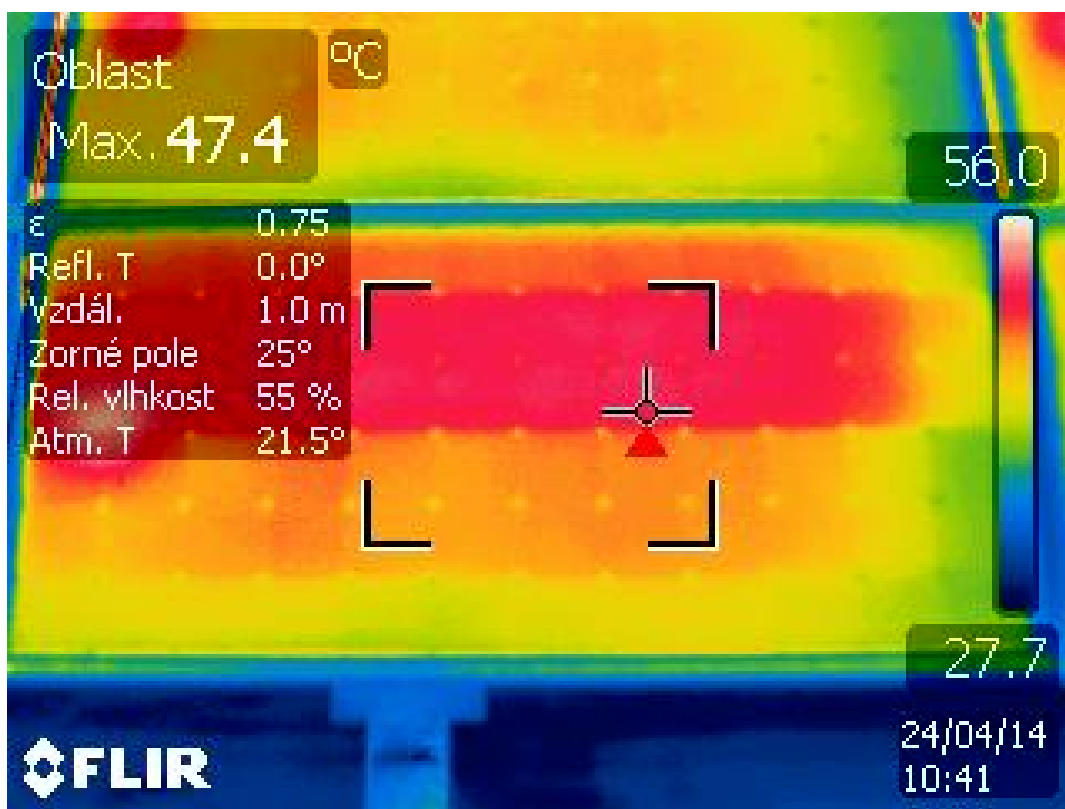
Obr. 19 Výrazně teplejší dva pásy článků (pozice 19.1.)
