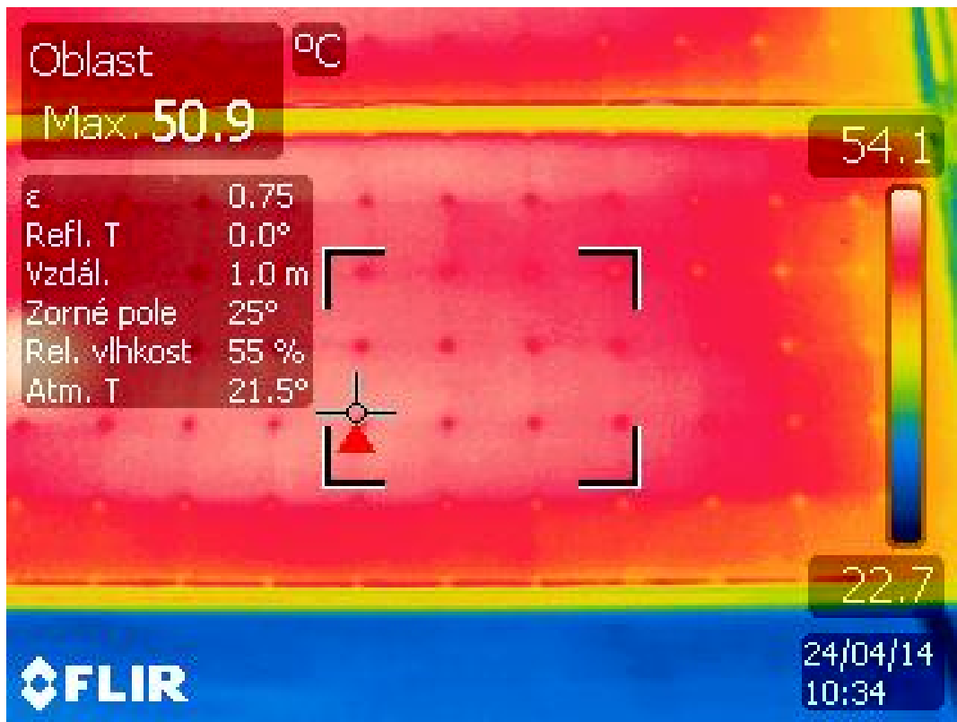
Obr. 14 Termosnímek správně fungujícího panelu
