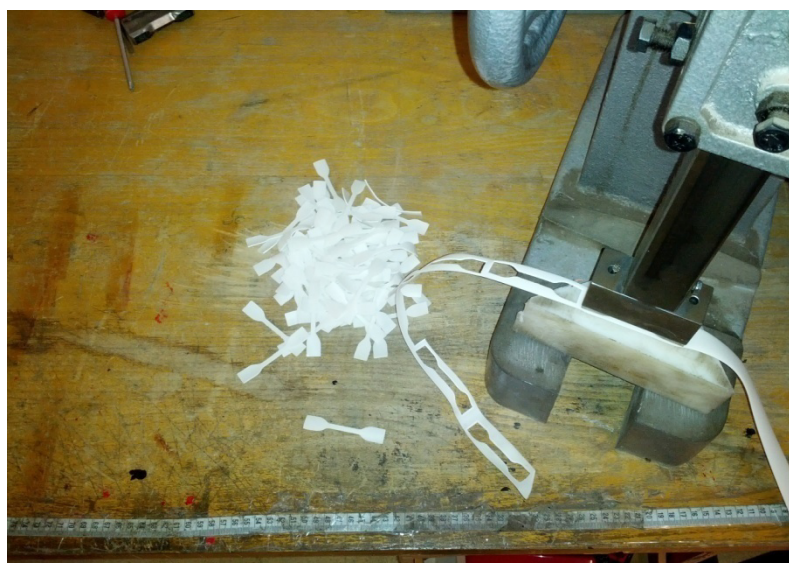
Obr. 3. 2 Příprava vzorků raznicí
