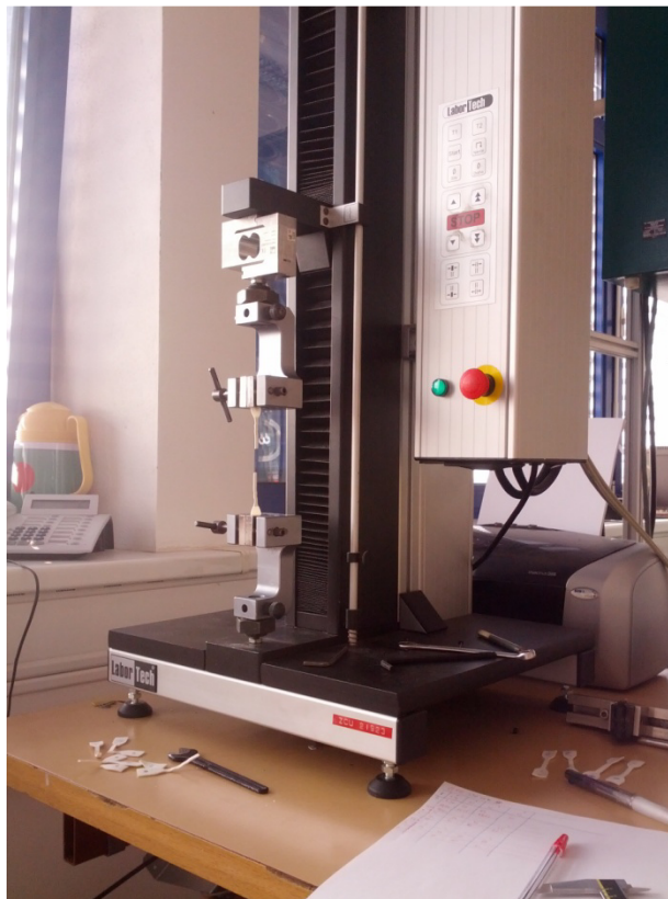
Obr. 3. 4 Zkouška mechanických vlastností jednoosým tahem
