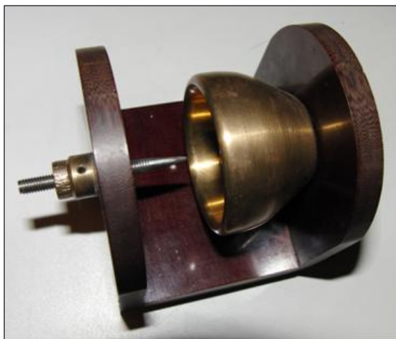
Obr. 3.14 Model pro měření korónových výbojů
