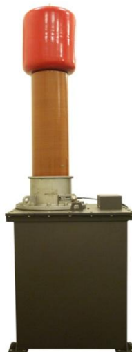
Obr 3.9 Vysokonapěťový zdroj zkušebního napětí[17]
