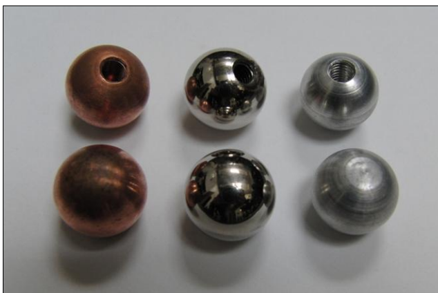
Obr 3.18 Kulové elektrody použité při měření (Cu, nerezová ocel, Al)
