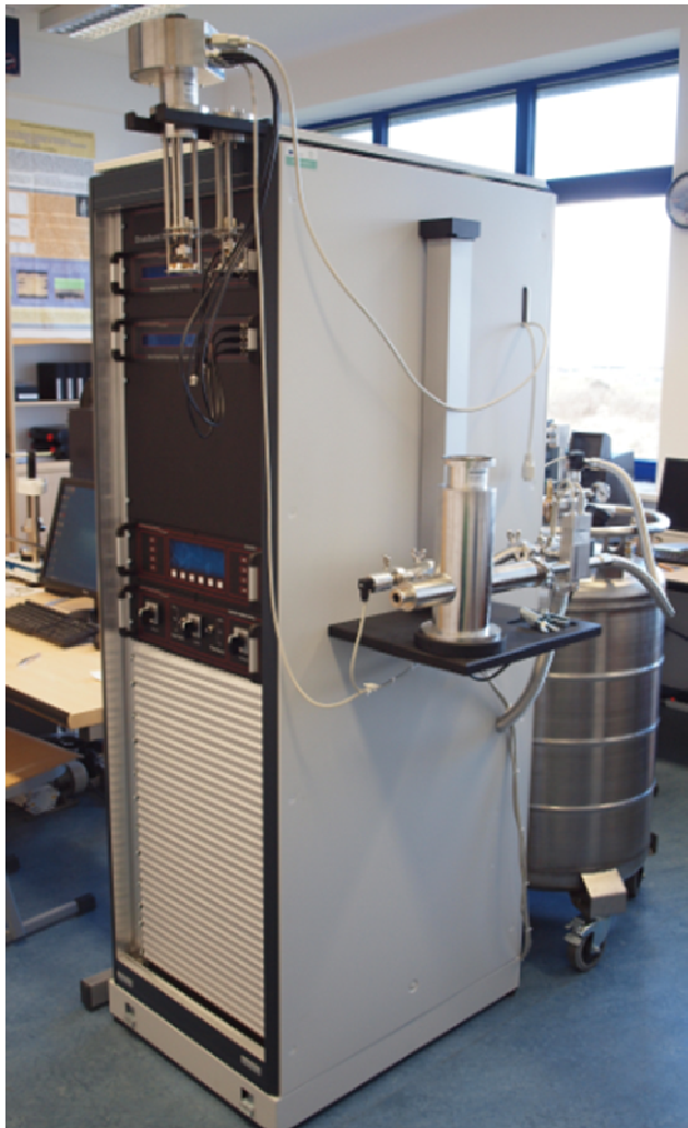
Příloha 9 - Měřicí systém Novocontrol – měření ztrátového činitele a permitivity
