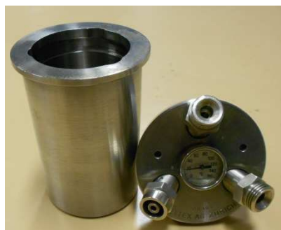
Příloha 7 - Měřicí systém Scheringova můstku – měření ztrátového činitele a permitivity
