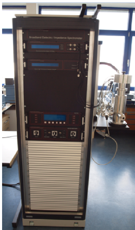
Obr. 6.8 - Měřicí systém Novocontrol
