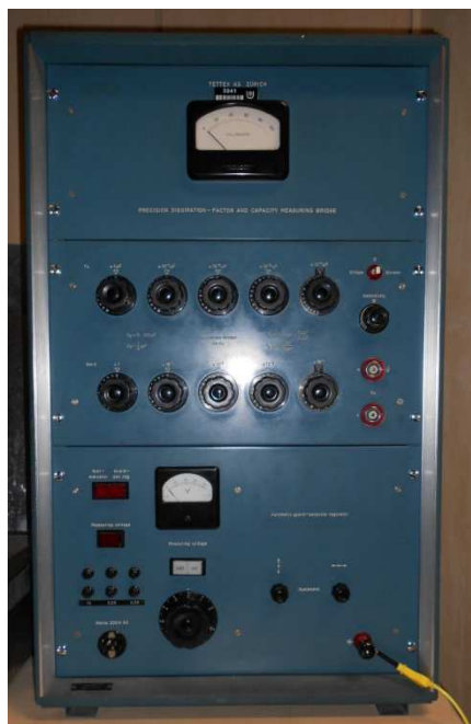
Příloha 7 - Měřicí systém Scheringova můstku – měření ztrátového činitele a permitivity
