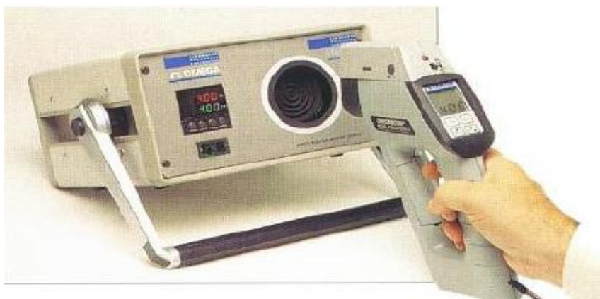
Obr. 2.10 Kalibrace bezdotykového teploměru [22]
