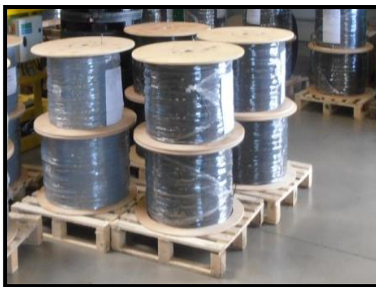
Obr. 31 Kabely skladované na paletkách při dodání
