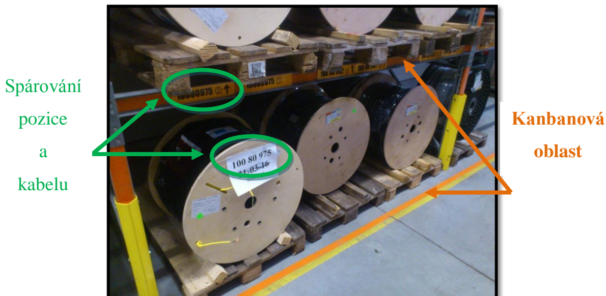
Obr. 33 Skladování kanbanových kabelů na příslušných pozicích ve skladu
