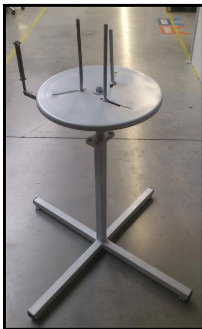
Obr. 52 Upravený ruční navíječ kabelů
