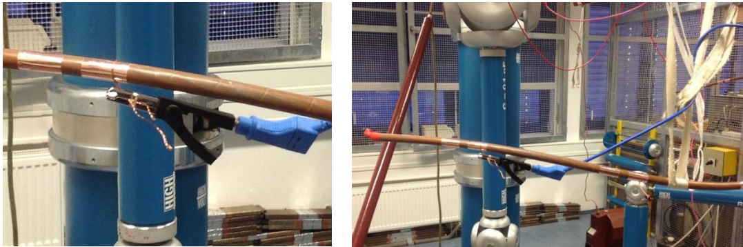
Obr. 15 Měření ztrátového činitele a permitivity: a) detail zapojení měřící elektrody, b) zavěšení měřeného vzorku v prostoru.
