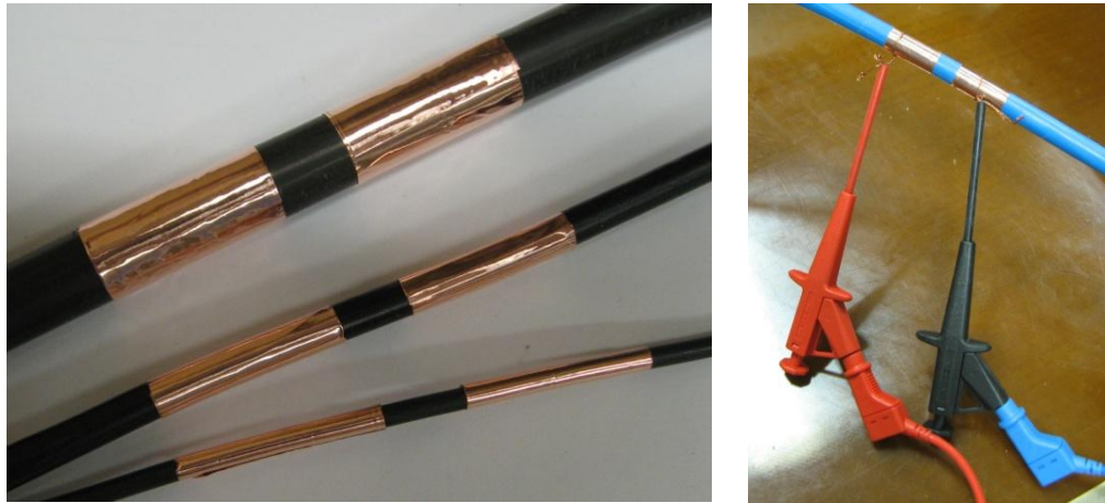
Obr. 14 Měření povrchového odporu: a) detail měřících elektrod na třech různých průměrech žíly, b) detail zapojení měřících elektrod při samotném měření.
