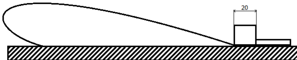
Obr 23: Schematické znázornění metody ploché smyčky. Převzato z [37]
