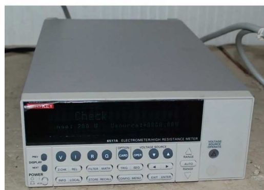
Obrázek 9: Elektrometr KEITHLEY 6517A [12]
