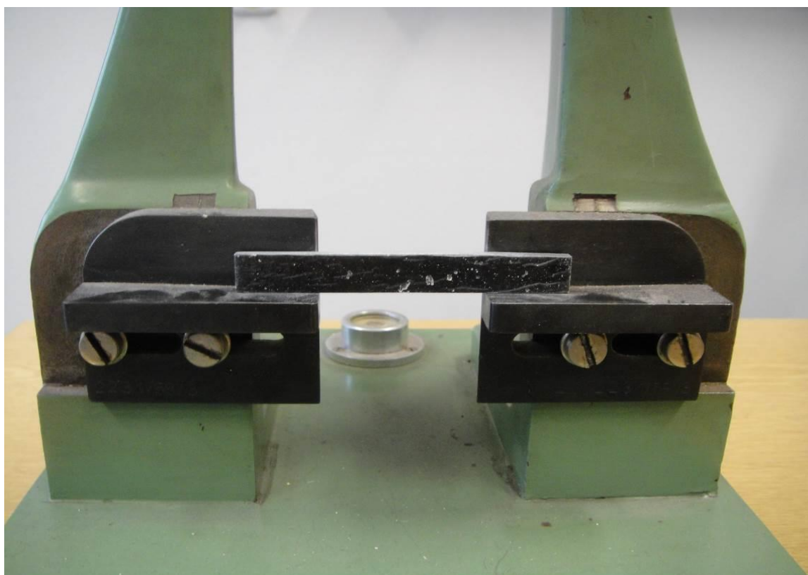
Obr. 4-4 Detail uložení vzorku na podpěry
