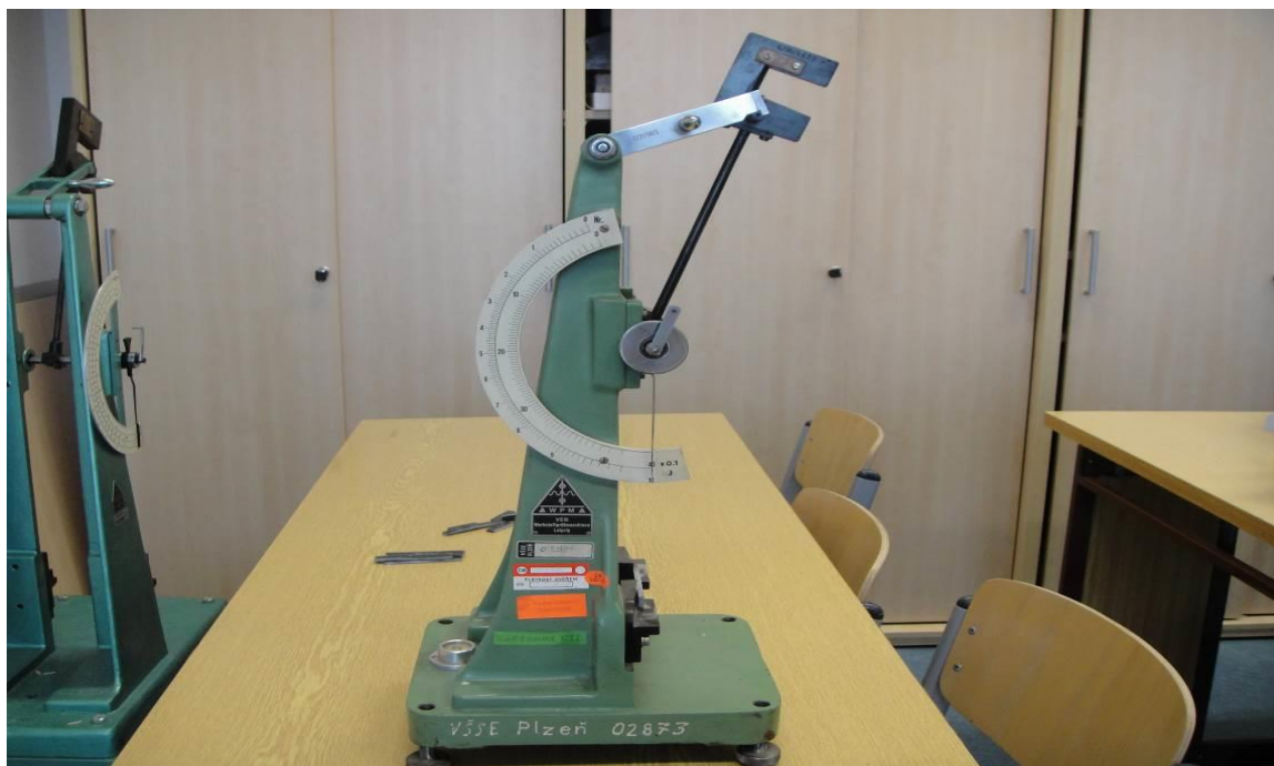
Obr. 4-3 Charpyho padostroj, na kterém probíhalo měření
