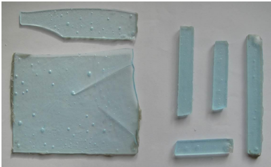
Obr. 4-6 První vzorky po vyjmutí z formy
