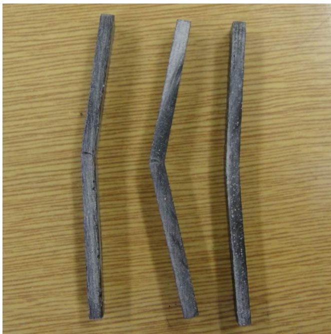
Obr. 5-5 Vzorky po zkoušce ohybem v pořadí A B C
